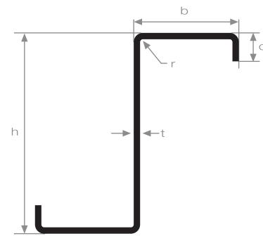
\* Kompakt olmayan profillerdir. Etkin kesit hesabına göre hesaplara yansıtılacaktır.
